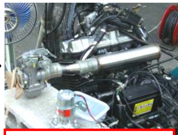
エンジン単体での動作試験
