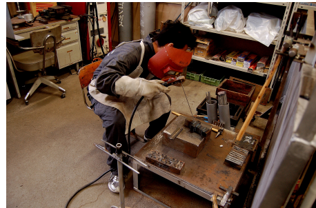
図11 溶接練習（左がTIG溶接、右がアーク溶接）
