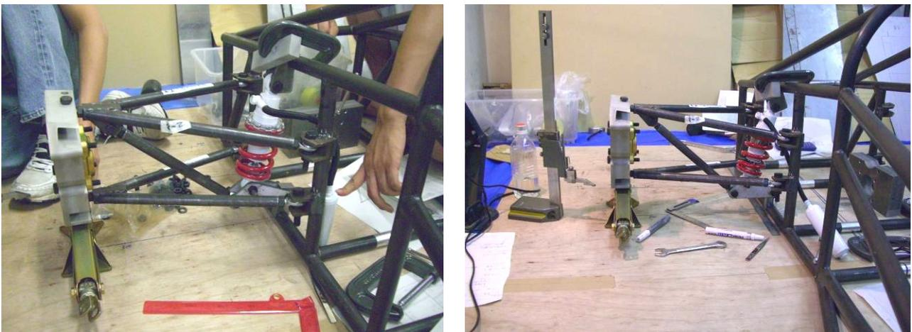
図3 サスペンション取り付け完了
