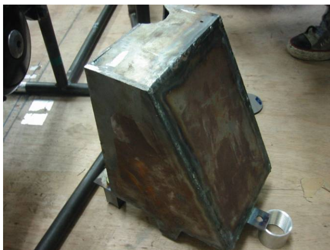
図 7 鉄製の燃料タンク
