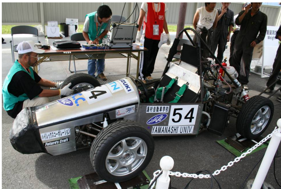
図 6 大会時の車両重量測定の様子
