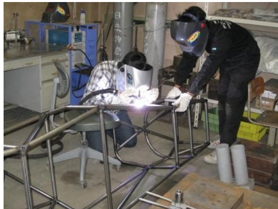
フレームの溶接風景
