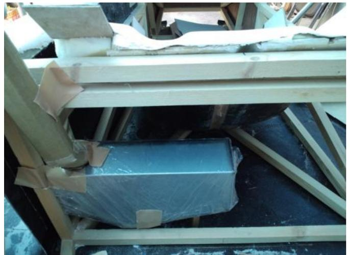
3DCAD 図面に従って実寸大フレームのモックアップと FRP で製作されるドライバーシートのオス型を利用した干渉チェック。かなり余裕が見られます。
