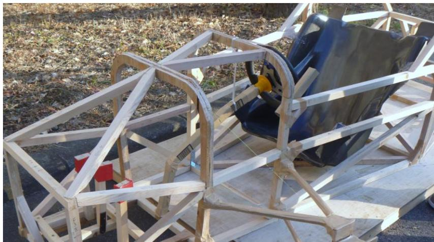
図 1 シート、ペダル、ステアリングの仮設置
