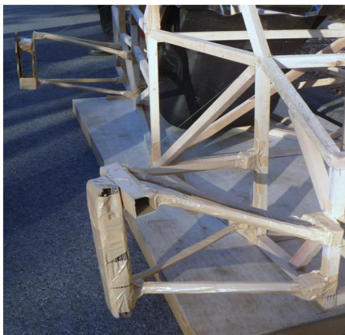
図 3 フロントサスペンション及びリアサスペンションの簡易的実寸大モデル
