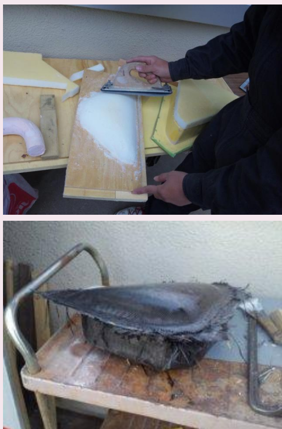
Fig 5 サージタンク製作
