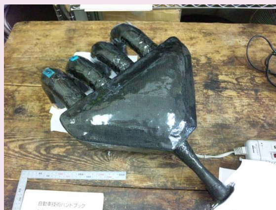
Fig 9 サージタンク
