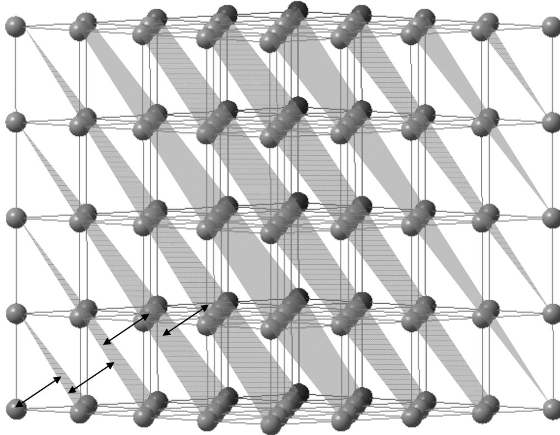
各面間の間隔 = 原点と原点に最も近い面までの距離
