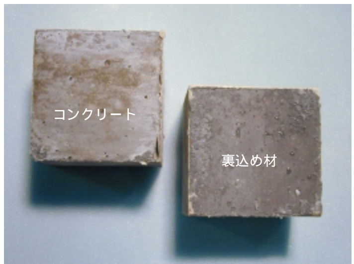
写真2 実験後の滑動面の状況
