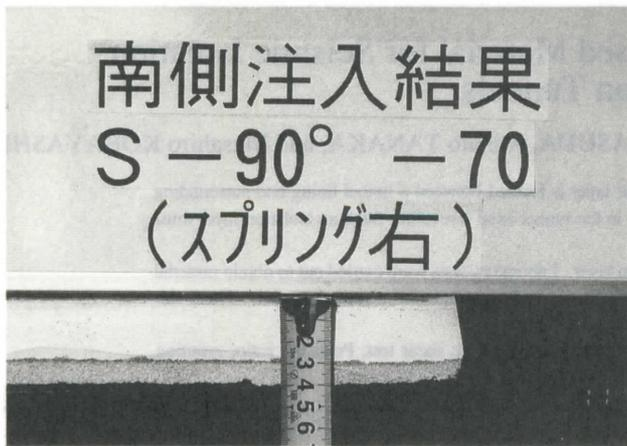
Photo.4 切出した免震層とその外周の砂との混合層
