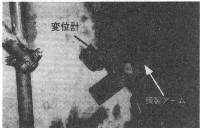
写真-3 セグメントと立坑側壁の相対変位の計測
