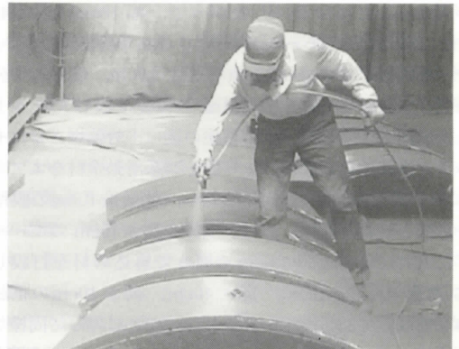
写真-7 スプレーによる滑動塗料の塗布
