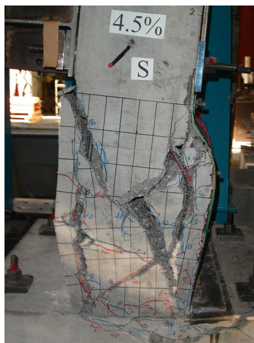
写真-7 CFRPシート4層で耐震補強した場合の 損傷状況（载荷終了時、S面）
