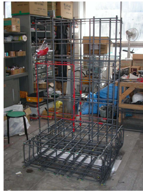
写真-1 供試体の配筋 (内側面からみた場合)
