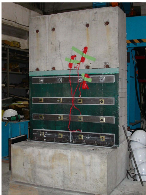
写真-3 CFRP シートで耐震補強した供試体（ケース 4 内側面から見た場合）
