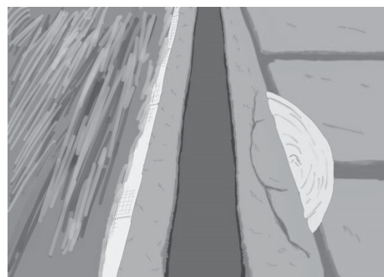
図-3 河川変状図 (堤防斜面に亀裂 (住宅側漏水))
