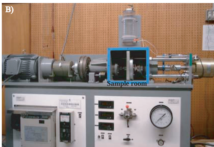
図5.8 回転式高速剪断摩擦試験機の写真と摩擦実験方法の模式図(京都大学嶋本研究室提供)。ガウジを挟む円柱状試料(径25mm)には、透明な石英ガラスを使用し、ガウジの周りには漏れ防止用のテフロンシールが巻いてある。一定の軸応力の下で、円柱状ガラスの一方は固定し、もう一方は回転させることにより、摩擦熱を発生させる。
