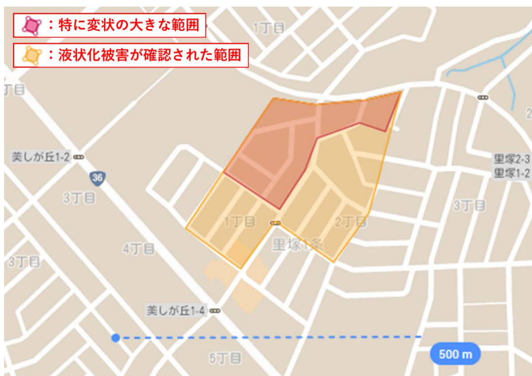
図 7 札幌市 清田区里塚における液状化被害範囲
